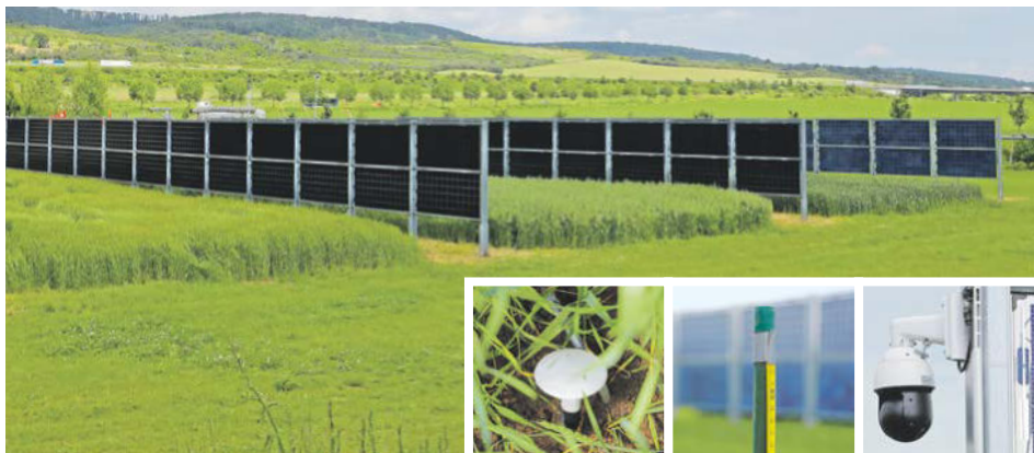
Auf der Demo-Anlage finden wissenschaftliche Untersuchungen statt. Sensoren messen die Bodenfeuchte, und mit Maßbändern und Kameras wird das Pflanzenwachstum verfolgt.
